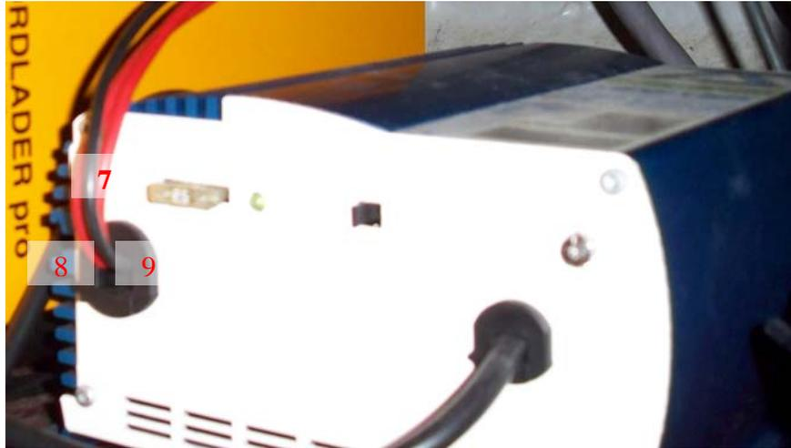
Les fils rouges + 7 et 8 vont aller aux deux batteries de démarrage. Le fil 9 – est le commun – normalement en bleu.
